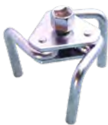
⊕ Clé à filtre de 63 à 120 mm REF : PP-AST201
